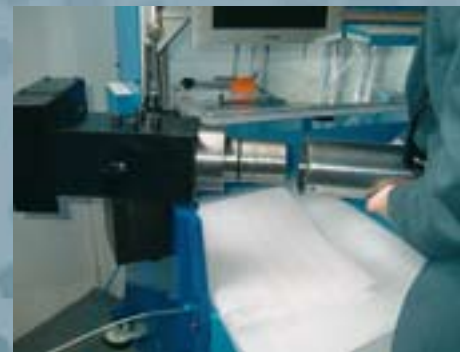
Cambio mandrino su gruppo multi-mandrino Mandrel change-over on multiple shaft system
