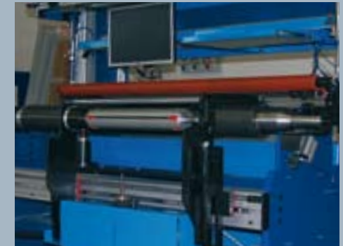
Supporto nastro biadesivo con albero ad espansione Sticky-back frame support with expandable shaft
